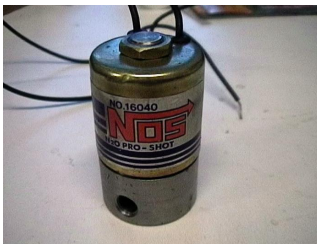
Ventil som anvendes til tilførsel af lattergas (ilt) til motorsportsvogne. Måtte kasseres p.g.a. for ringe levetid
