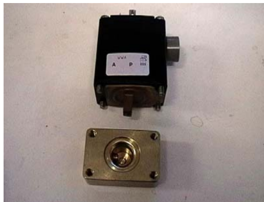
Vippeventil som anvendes i industrianlæg, hvor der kræves stort flow og lille reaktionstid. Måtte kasseres p.g.a. at de fire ventiler ikke regulerede ens, og fordi flowet gennem ventilen skiftede fra laminar til turbulent, når brinttilførelsen blev forøget, hvilket medførte at flowet faldt i stedet for at stige.
