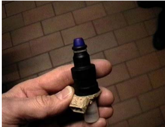
Gasdyse som anvendes til naturgasbusser. Måtte kasseres p.g.a. for ringe flow.
